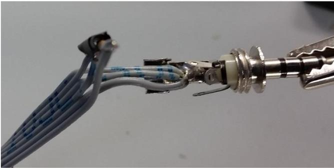
Saldare il filo 1 unito con le resistenze al contatto microfono del jack (è il contatto che coincide con il terzo anello a partire dalla punta del jack)
