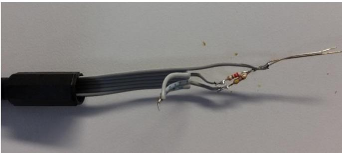
Isolare con un po' di nastro isolante il filo 5 dal filo 3
