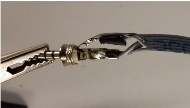
Richiudere il tutto ed isolare con nastro adesivo
